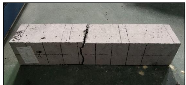
Gambar 6. Keretakan Akibat Pengujian Kuat Lentur
