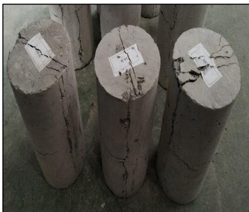
Gambar 4. Keretakan Akibat Pengujian Kuat Tarik Belah
