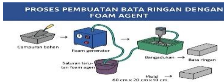
Gambar 1. Ilustrasi Proses Pembuatan Benda Uji
