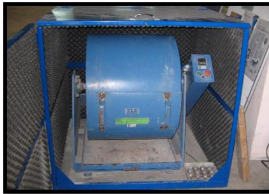
Gambar 2. Mesin Los Angeles (L.A) digunakan untuk pencanaian
