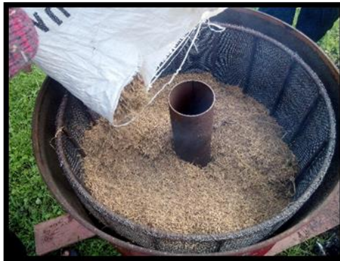
Gambar 1. Sekam padi di dalam PAF_RHA
