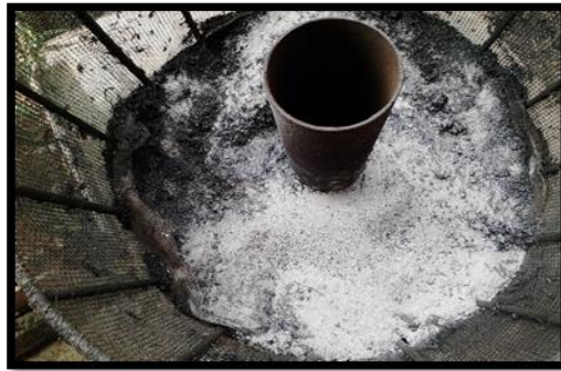
Gambar 3. Abu sekam padi di dalam jaring besi
