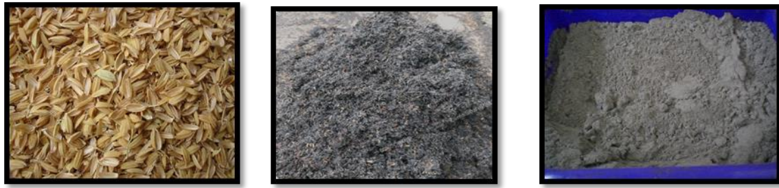
Gambar 4. Sampel sekam padi dan abu sekam (RHA) selepas dicanai
